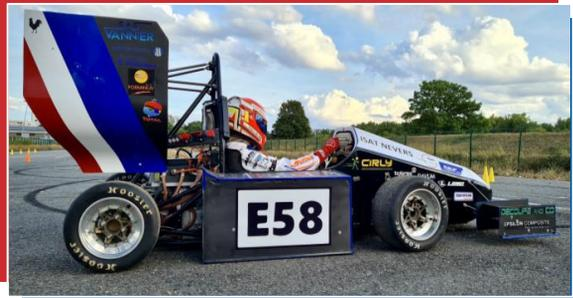
**S**KID PAD : La voiture doit réaliser le plus rapidement possible quatre tours d'un circuit en forme de huit, deux dans chaque sens. C'est ici l'adhérence en virage de la voiture qui est mise à l'épreuve.
